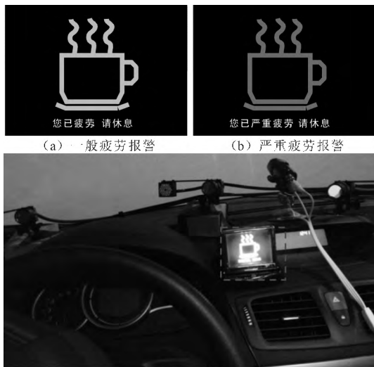
(c) 疲劳预警设备实物图 图 4 疲劳预警提示设备 Fig. 4 Fatigue warning device
